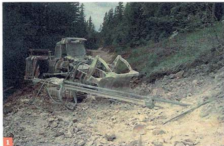
Alte und neue Bohrtechnik. Hier handelt es sich um eine „selbstgebaute“ Bohrlafette (1) und eine Wimmer-Anbaubohrlafette (2). Diese kommen für Sprengungen im Zuge des Forststraßenbaus zum Einsatz
